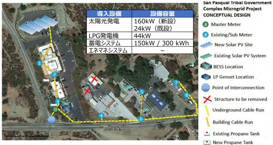
図 2.20 San Pasqual Band of Indians Microgrid のシステム構成
