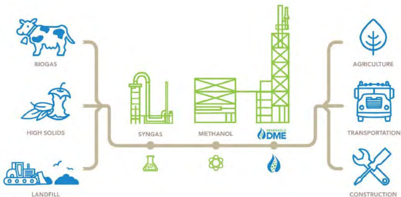
図 56 DME の製造 (Oberon の小規模製造プロセス)
